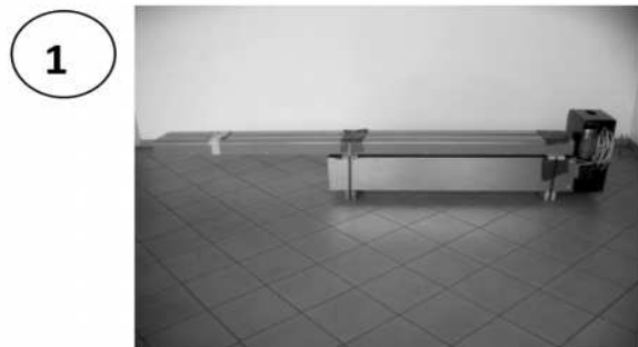
Pasar los cables de las fotocélulas y unir el bastidor horizontal con los verticales
